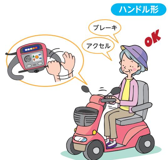
※4 アクセル(レバー):アクセルレバーを押す(または引く)と、モーターに電気が流れ発進します。
