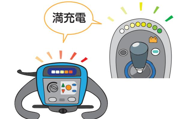
※1 バッテリー:充電をして繰り返し使用できる蓄電池です。電動車いすは、バッテリーに蓄えられた電気でモーターを回して作動します。バッテリー内の電気がなくなると使用ができなくなりますので、使用する前には十分に充電をしてください。
